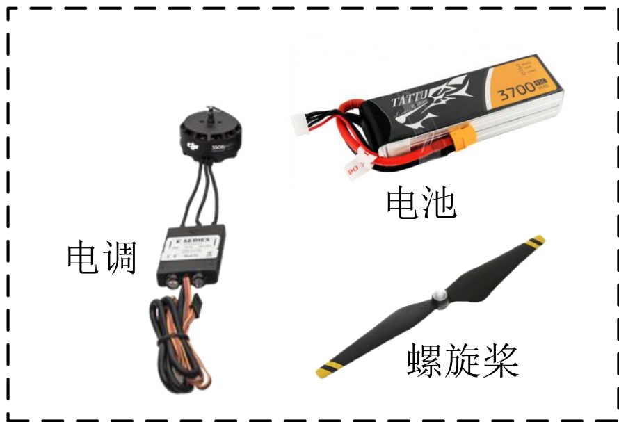
图. 多旋翼动力系统
