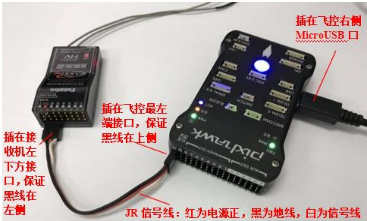
图. 硬件系统连接
