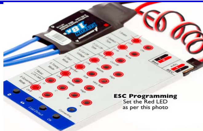
图2.12: 好盈无刷电调参数编程卡
