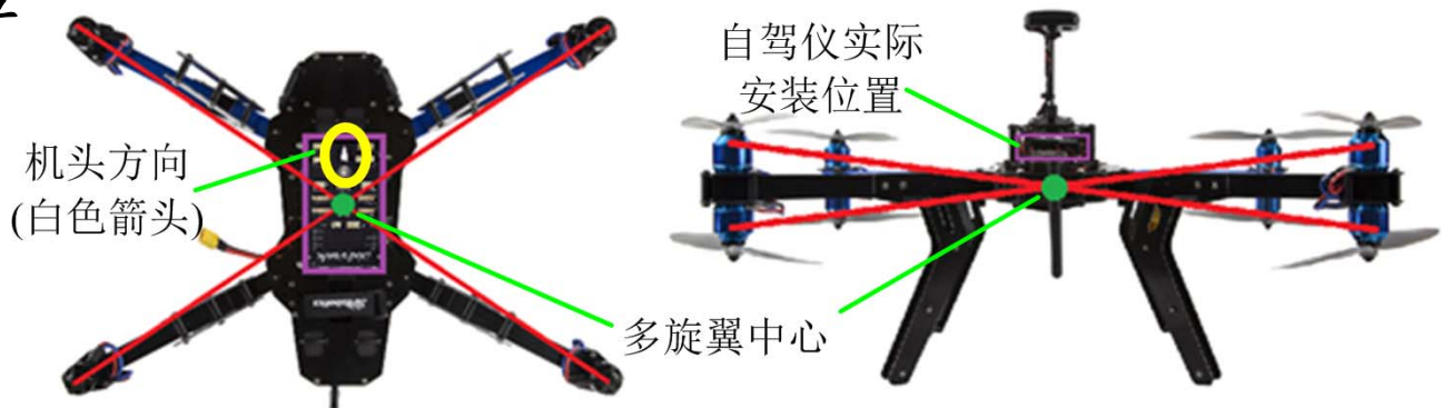
图3.11: 飞控板安装位置
