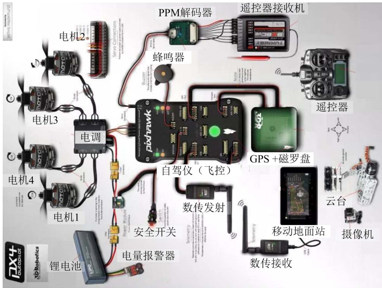
图2.2:多旋翼内部布局, 图片主体来源于网站 ardupilot.org
