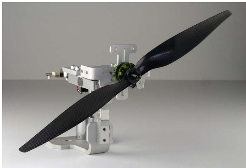
图 6.15 专业动力系统测量装置RCbenchmark-1580 2
